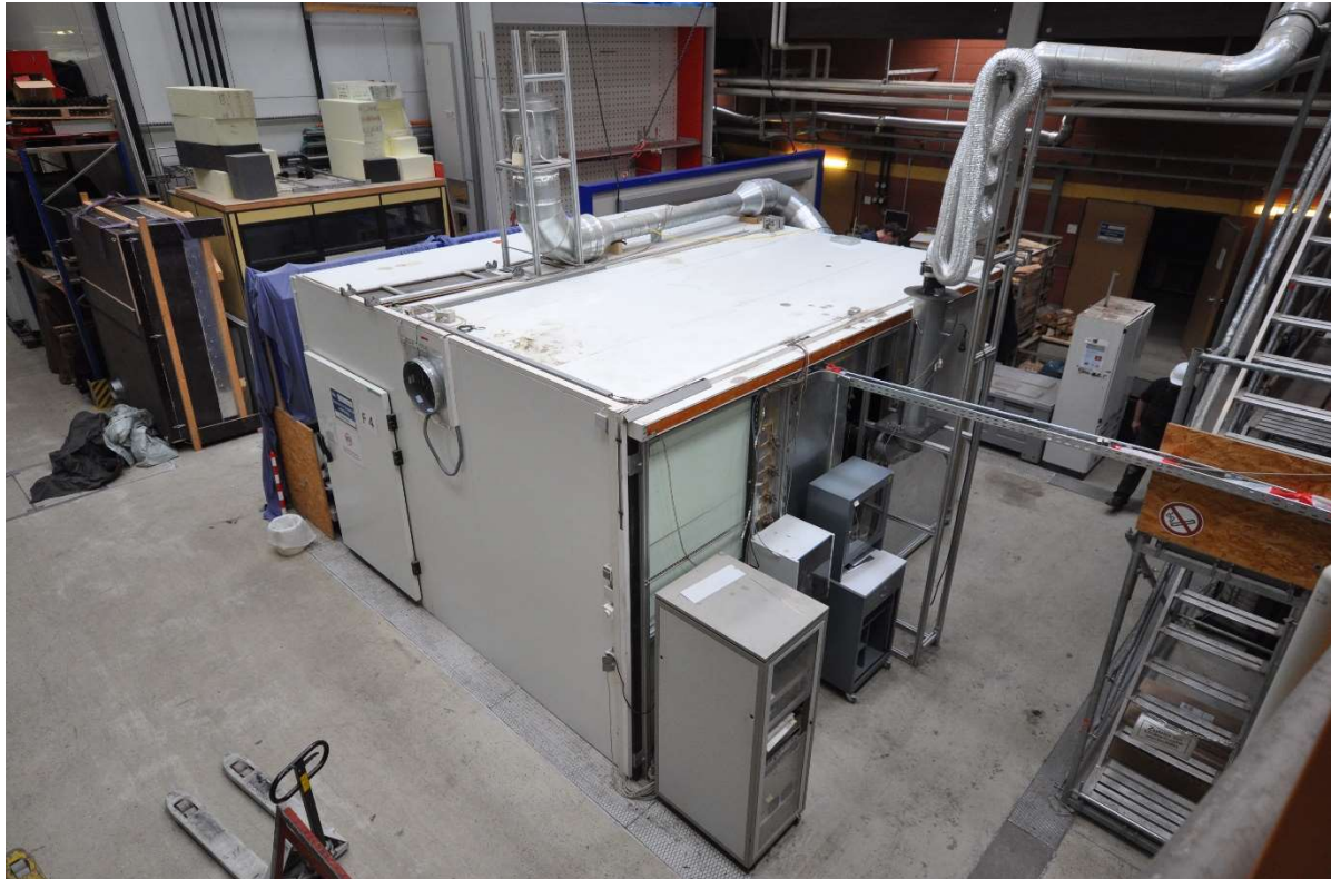
Abbildung 2: Technische Versuchseinrichtung (Kalorimeterraum) zur Bestimmung von Energiebilanzen.
