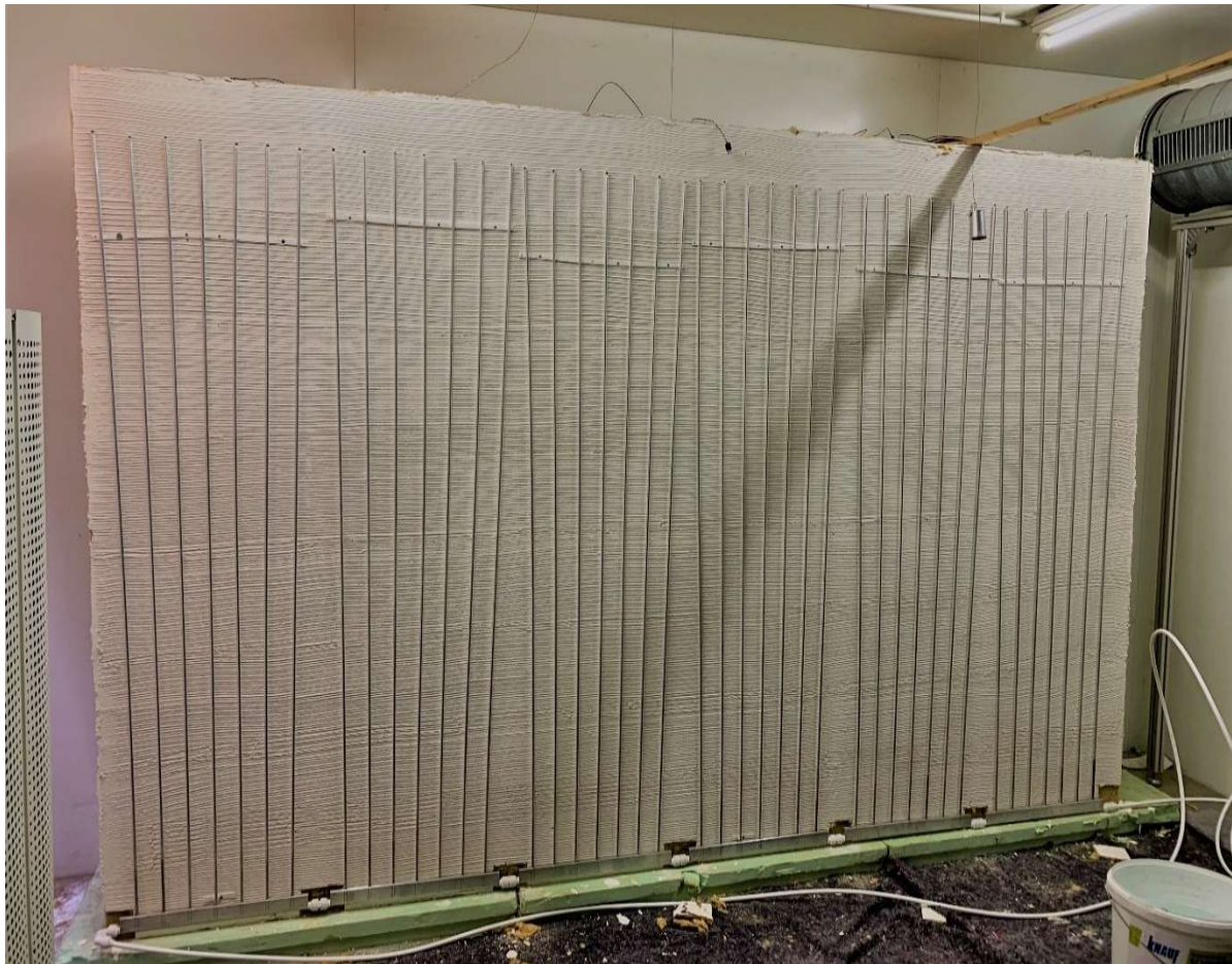
Abbildung 7: Das Wandheizsystem zusammengebaut aus sechs in Reihe geschalteten Heizmodulen, welche an der Musterwand angebracht sind.
